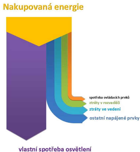
Obrázek 1 – Sankyeho diagram toku energií SVO
